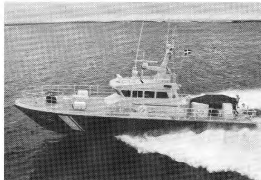
KBV 301-serien utgör 2000-talets patrullfartyg byggd i aluminium på Karlskronavarvet i en serie om tio fartyg. Fartygen har vattenjetdrift, fart ca 35 knop och fyra mans besättning.
