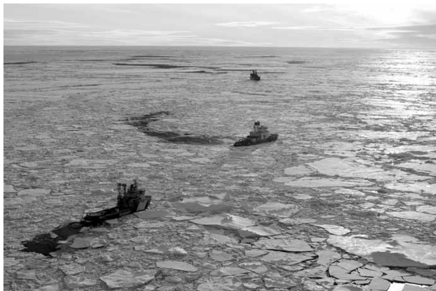
Figur 3. Oden bryter is framför Vidar Viking under expeditionen Arctic Coring Expedition (ACEX) 2004. Längst bort i bilden syns den ryska atomisbrytaren Soviet-sky Soyus. Under ACEX-expeditionen borrades för första gången någonsin en längre (428 m lång) sedimentkärna i den centrala Arktiska oceanen genom att en borrhigg installerades på Vidar Viking. Kärnan borrades på det c:a 1300 m djupa krönet av Lomonosovryggen vid 88°N. ACEX är den enda hittills genomförda borrexpeditionen till centrala Arktiska oceanen. Sedimentkärnan innehåller 56 miljoner år av Arktis utvecklingshistoria. Expeditionen resulterade i stora vetenskapliga genombrott och fler publikationer i de prestigefyllda forskningstidskrifterna Nature och Science än någon tidigare borrexpedition inom Ocean Drilling Program (ODP) och det efterföljande Integrated Ocean Drilling Program (IODP). En syntes av de viktigaste resultaten har skrivits av Jan Backman från Stockholms universitet och Kate Moran, som under tiden för ACEX var verksam vid University of Rhode Island. 7 Den svenska kunskapen om att operera i den arktiska packisen var central för genomförandet av borrhningen. ACEX-expeditionen är ett bra exempel på att Oden har gett Sverige en särställning avseende operationer i och kunskap om den centrala Arktiska oceanen.
