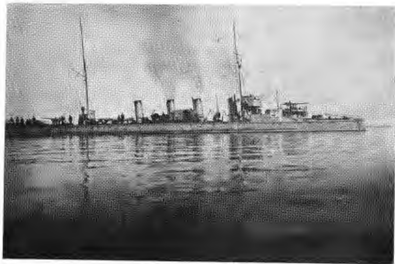
Torpedbåten S 3 (ex Poslusjnyi=Lydig) av Sokol (Falk)-typ. Sjösatt 1898 i Åbo. Depl. 240 ton. Fart 27 knop. Två 75 mm kanoner, en 450 mm torpedtub. Dimensioner: 58×5, 6×2,3 m.
