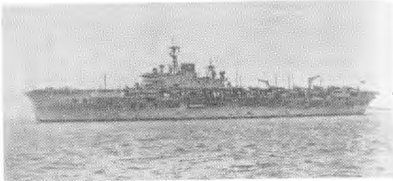
Brittiska hangarfartyget »Eagle» om 36.800 tons standard. Deplacement fullt rustat = 46.000 tons. Längd ö. a. = 245 m. Största bredden är c:a 34 m. Maskinanläggningen utgöres av fyra ångturbinanläggningar om sammanlagt c:a 160.000 hk och högsta fart är 31,5 knop. Bestyckningen utgöres av 16—11,5 cm kanoner i 8 dubbeltorn och 57—40 mm akan. (Engineer.)
