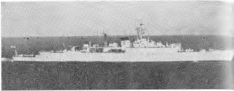
Brittiska fregatten »Venus», f d jagare, byggd 1943. Depl. = 1.710 tons std. Turbinmaskineri om 40.000 hk. Fart = 34 knop. Bestyckning: 2—10 cm kan. i dubbeltorn, 2—40 mm akan, 2 fasta 53 cm torpedtuber, 2-squidlavettage. (Engineer.)
