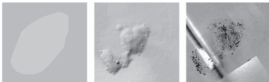
Bild 6. De tre bilderna visar samma bottenyta. Den vänstra visar genom färgkoder maringeologin, den mellersta visar djupdata från ett multibeamekolod och den högra högupplöst sonardata.
