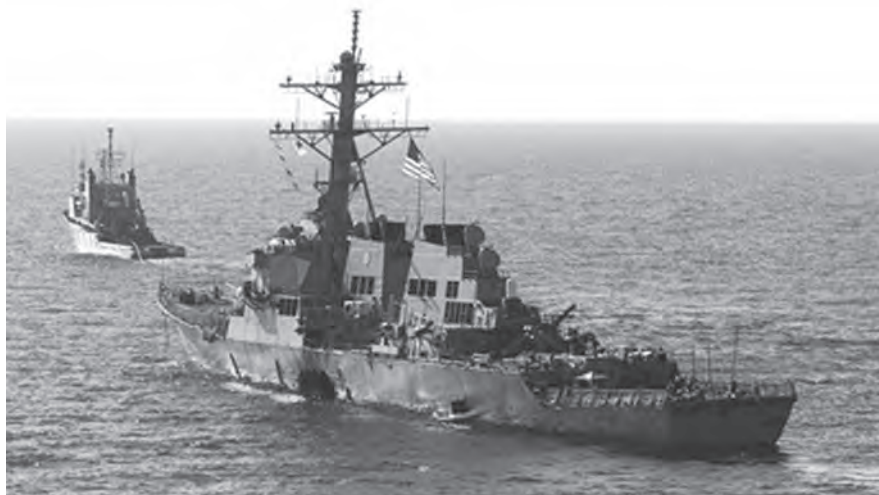
USS Cole under bogsering efter attentatet. Hålet i skrovet vid vattenlinjen på BB-sidan är stort men räckte inte för att sänka fartyget. Hon reparerades och kom åter i tjänst 2003. Foto: US DoD.
