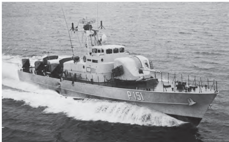
Bild. 1. Patrullbåten P151 Hugin, LÖA 36 m, deplacement 145 ton, toppfart 30–35 knop. Maskineri: 2 st. 20 cylindrars V-diesel, 3 500 hk (ursprungsmotor från 1927, 1 450 hk för zeppelinare). Beväpning: 6 st. sjömålsrobotar (Pingvin – IR), 1 st. 57 mm Bofors allmålskanon (sjömåls-, spräng-, kulspräng- och övningsammunition), 2 st. kulsprutor (ksp 58), 57 mm lys- och/alt. remsraketer. Radar- och eldledningssystem: Arte 726A. Radarsignalanalysator: PQ 858. Utrustad för ubåtsjakt med Simradhydrofon och sjunkbomber (två fällare samt däcksräls för ytterligare sjunkbomber). Besättning: 20 personer (åtta befäl och tolv vpl.). Foto: Marinmuseum.
